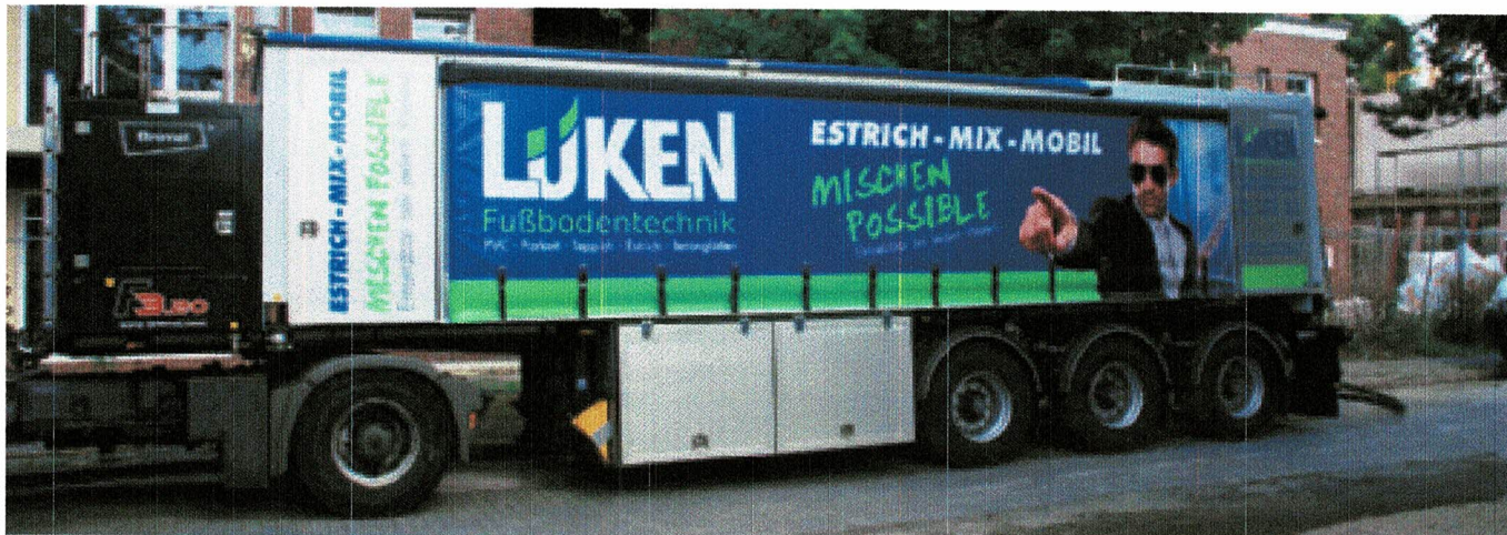
„Mischen Possible“ – die neue Zementestrichanlage Breemat F3.20 auf der Baustelle.
